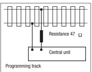
Cuando programe usando el equipo Lenz, Uhlenbrock o de Arnold, siga las instrucciones de programación del fabricante. Si aparece el mensaje de error "err02" durante la programación con el equipo Lenz o de Arnold, debe ser insertado entre uno de los dos cables suministrados y la pista programada una resistencia de 47 Ohm (0.5 Vatios o más).
