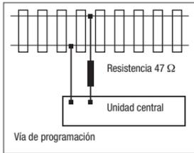
Cuando programe usando el equipo Lenz, Uhlenbrock o de Arnold, siga las instrucciones de programación del fabricante. Si aparece el mensaje de error "err02" durante la programación con el equipo Lenz o de Arnold, debe ser insertado entre uno de los dos cables suministrados y la pista programada una resistencia de 47 Ohms (0.5 Vatios o más).
